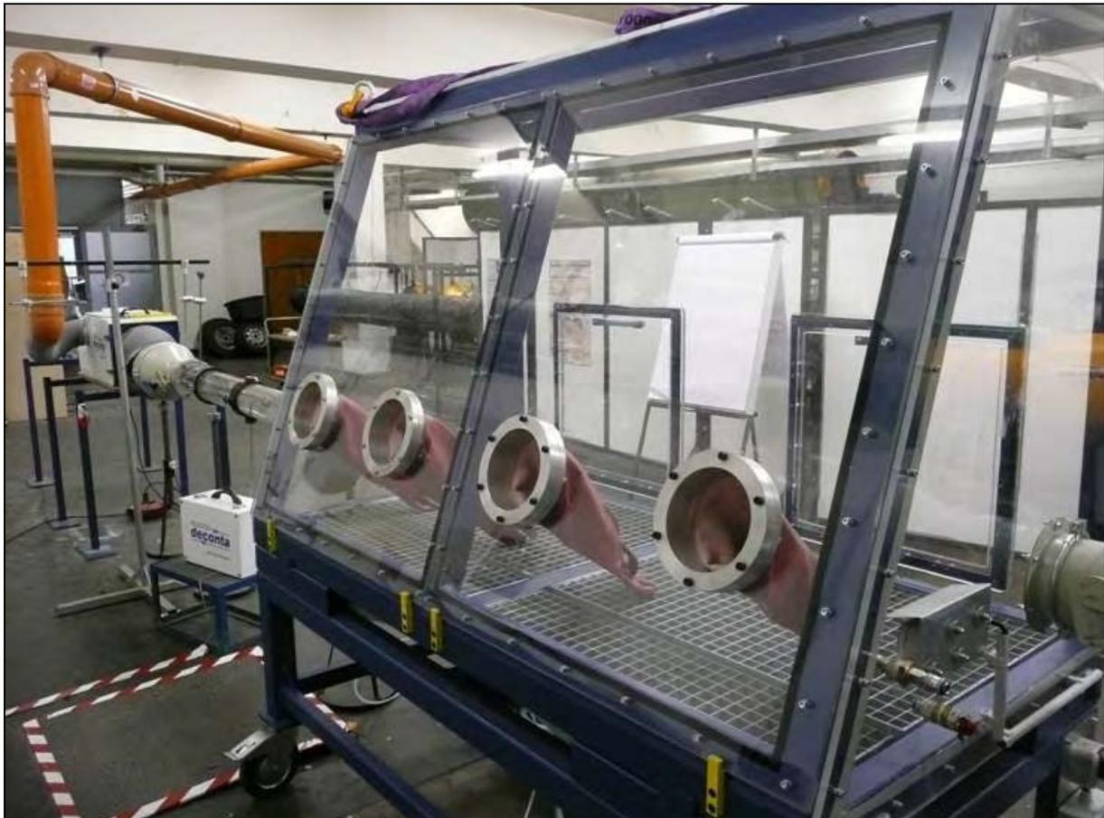
**Abbildung 1: Versuchsstand mit im Hintergrund erkennbarer Messstrecke und Unterdruckhaltung**
