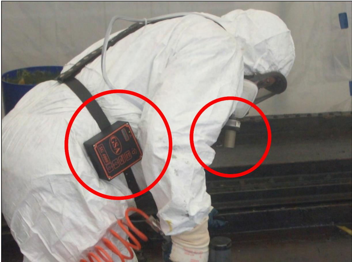
Abbildung 1: Probenahmegerät GSA 4000 im Einsatz
