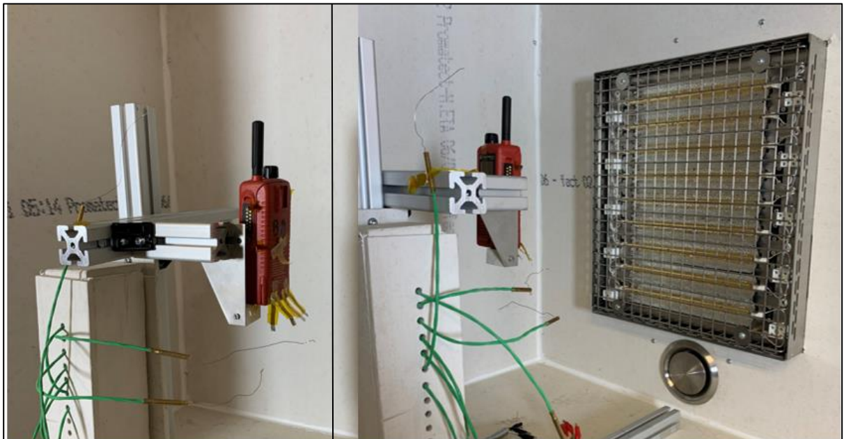
Abb. 17: Haltevorrichtung des Funkgeräts (links) und Position des Funkgeräts im Prüfstand (rechts).
