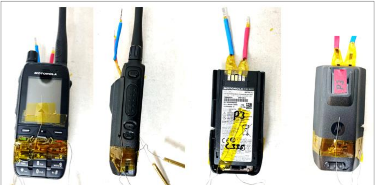
Abb. 46: Anordnung und Position der vier Temperatursensoren T1(rechts) bis T4(links) am Beispiel der MXP600-Serie
