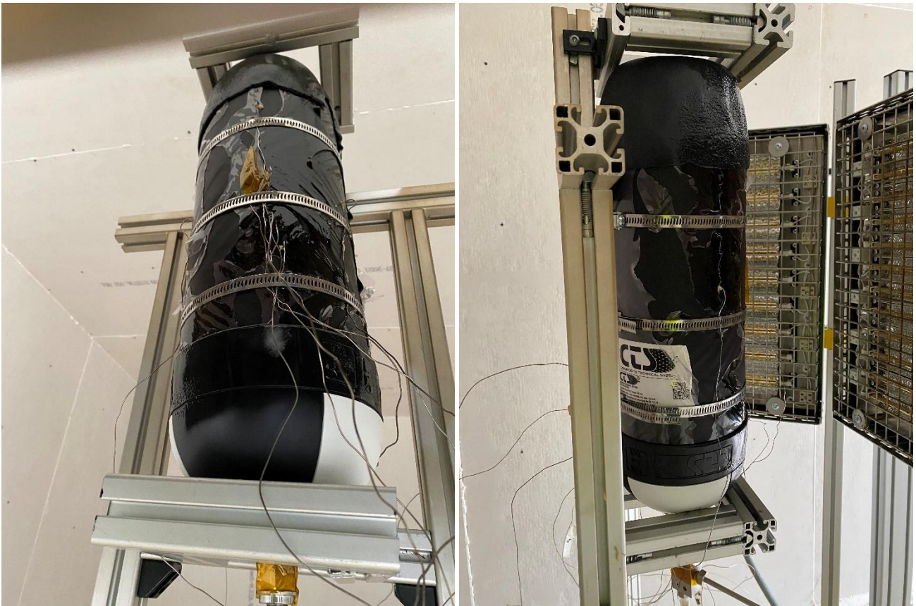
Abb. 37: Prüfmuster C52 der Fa. CTS nach hoher thermischer Bestrahlung ( T_{\text{Grund}}=110^{\circ}\text{C} , T_{\text{Max}}=150^{\circ}\text{C} )
