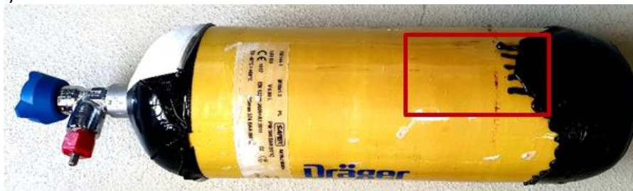
Abb. 29: Prüfmuster der Fa. Dräger nach mittlerer thermischer Bestrahlung ( T_{\text{Grund}}=80^{\circ}\text{C} , T_{\text{Max}}=110^{\circ}\text{C} ) (oben) und Detailansicht (unten)
