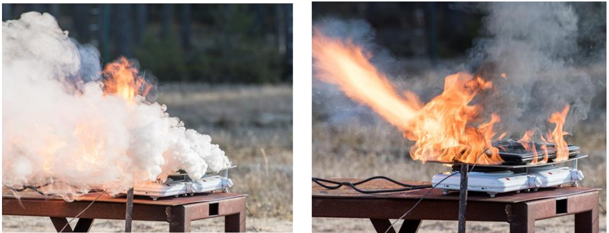
Abb. 1: Li-Ionen-Batterien in einem Laptop beim thermischen Durchgehen nach Erhitzen auf einer Herdplatte
