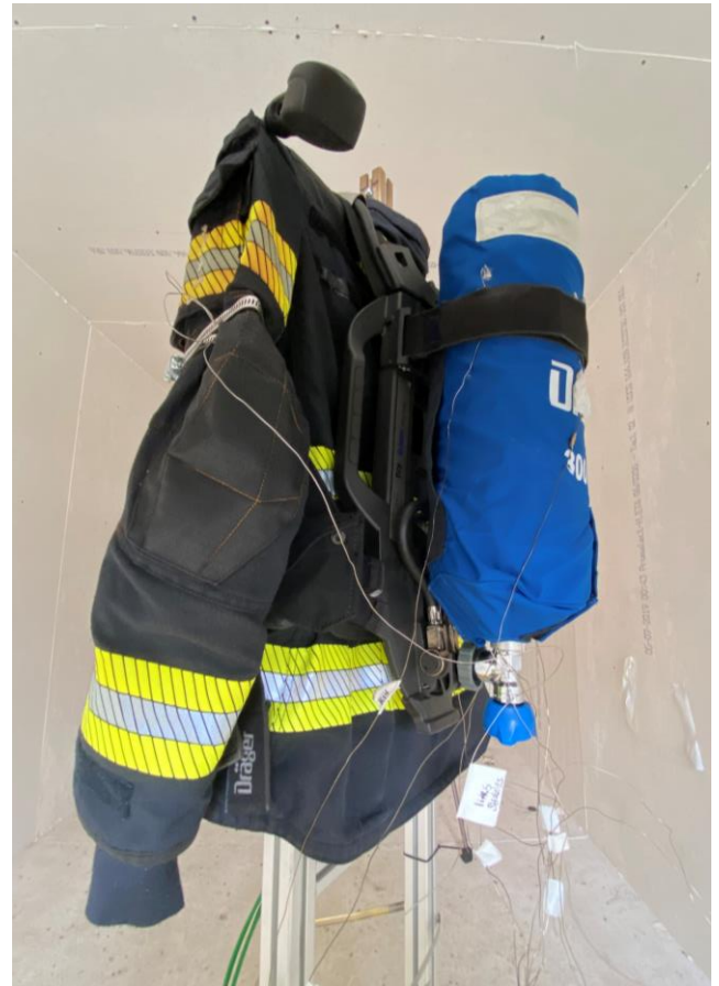
Abb. 31: Vergleichsversuche am Behälter D74 mit Schutzhülle und an dem Funkgeräten MTP850EX in der Jackentasche der Schutzkleidung
