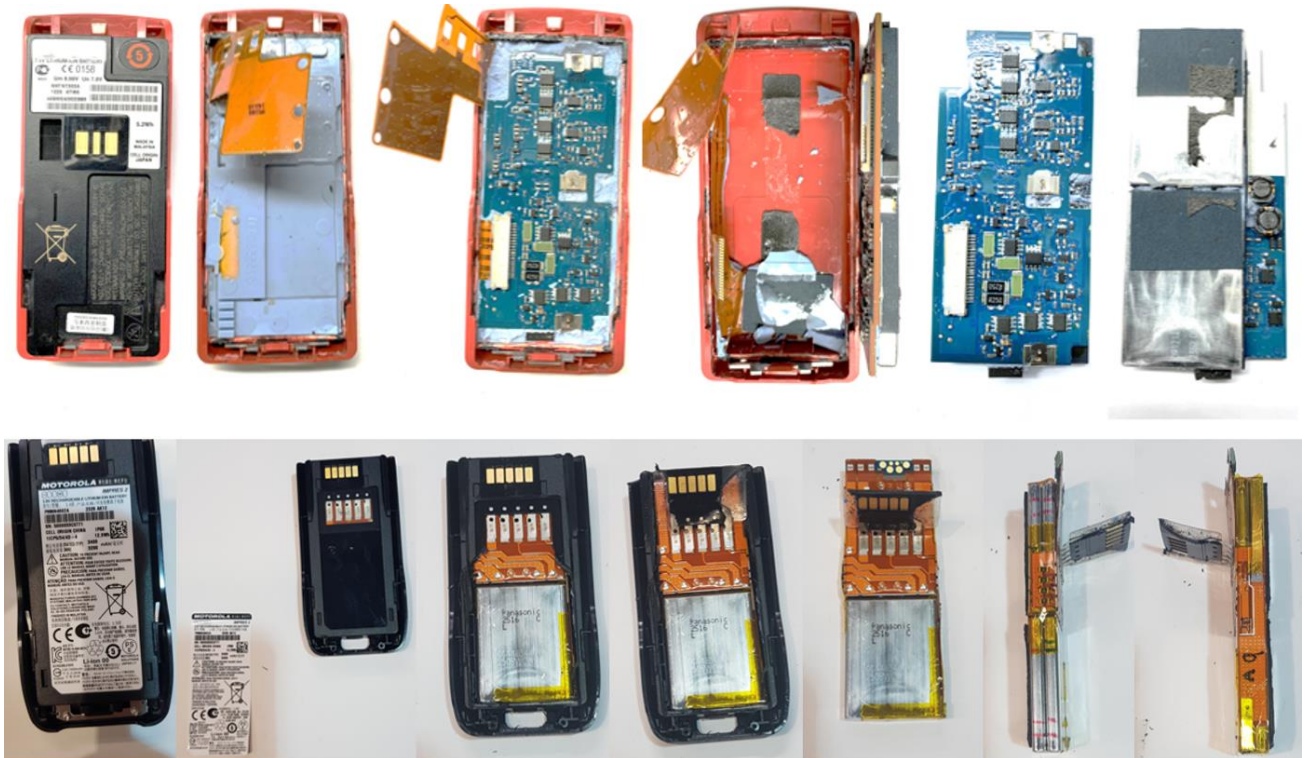
Abb. 48: Schrittweise Zerlegung eines MTP850Ex (oben) und eines MXP600 (unten) Akkus
