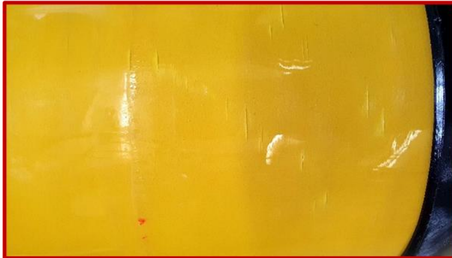
Abb. 29: Prüfmuster der Fa. Dräger nach mittlerer thermischer Bestrahlung ( T_{\text{Grund}}=80^{\circ}\text{C} , T_{\text{Max}}=110^{\circ}\text{C} ) (oben) und Detailansicht (unten)
