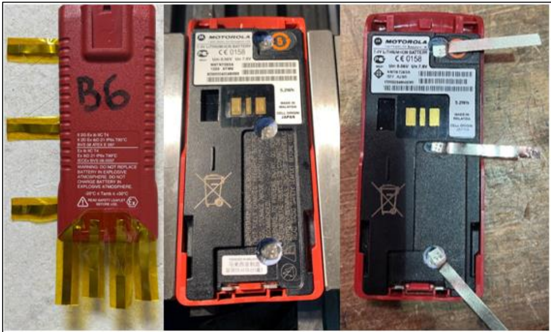
Abb. 16: Rückseite des Akkus inklusive angeschweißte Lötfähnchen (links), Position der freigelegten Kontaktierungsstellen (Mitte) und angeschweißte Lötfähnchen (rechts)
