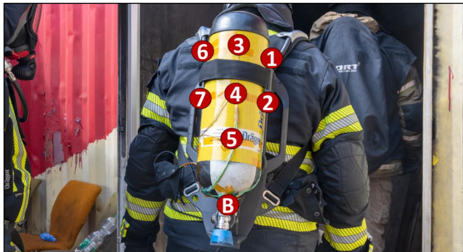
Abb. 22: Sensor- und Messpunkte zur Temperaturmessung an der Atemluftflasche.
