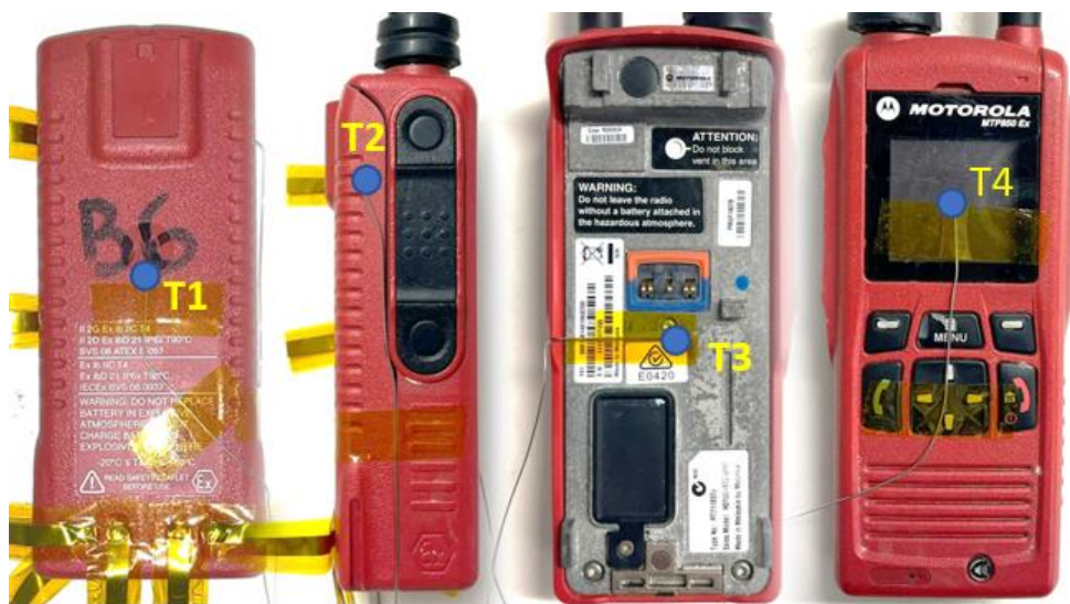
Abb. 24: Anordnung und Position der vier Temperatursensoren T1(links) bis T4(rechts) am Beispiel der MTP850Ex-Serie
