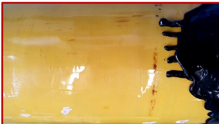
Abb. 30: Prüfmuster der Fa. Dräger nach hoher thermischer Bestrahlung ( T_{\text{Grund}}=110^{\circ}\text{C} , T_{\text{Max}}=150^{\circ}\text{C} ) (oben) und Detailansicht (unten)
