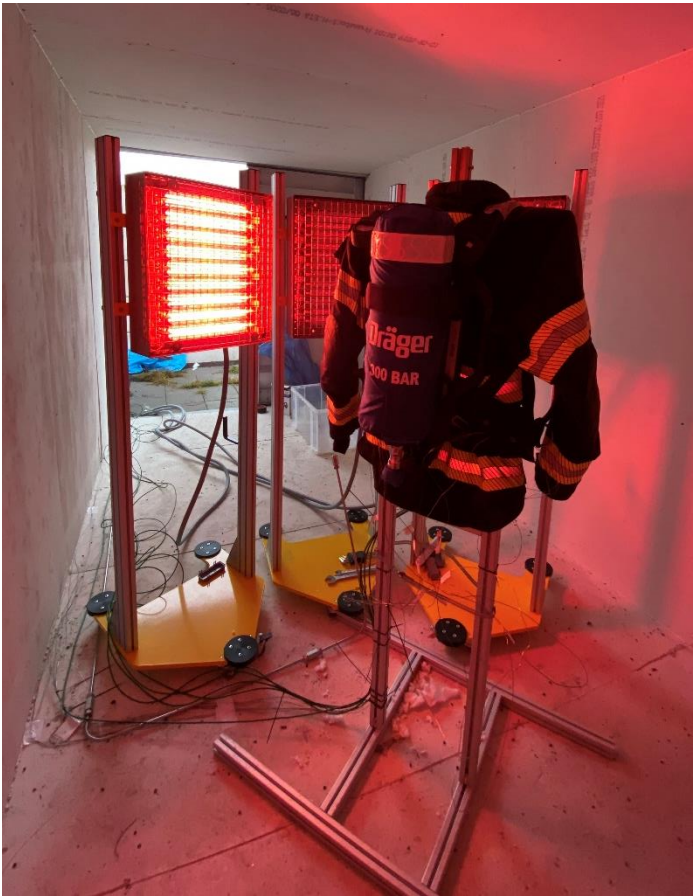
Abb. 31: Vergleichsversuche am Behälter D74 mit Schutzhülle und an dem Funkgeräten MTP850EX in der Jackentasche der Schutzkleidung
