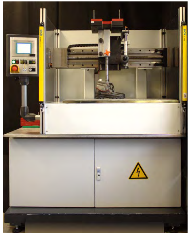
Abbildung 8: Fußboden- und Schuhtester [FG ARBSI 2012]
