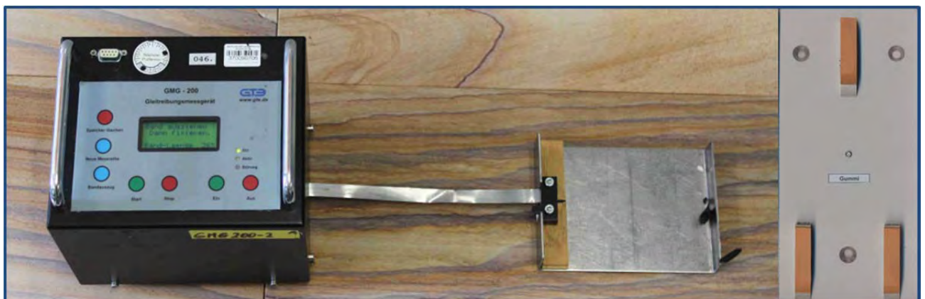
Abbildung 11: Gleitmessgerät 200 (links) und GMG-Gleiterplatte (rechts) [FG ARBSI]
