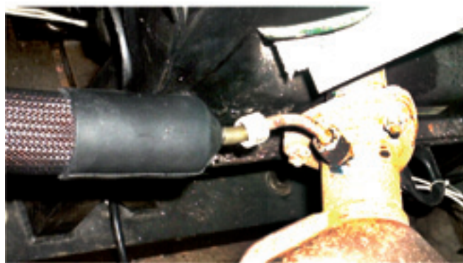
Probennahme am Punkt I des Benzinmotors im Leerlauf und bei mittlerer Belastung
