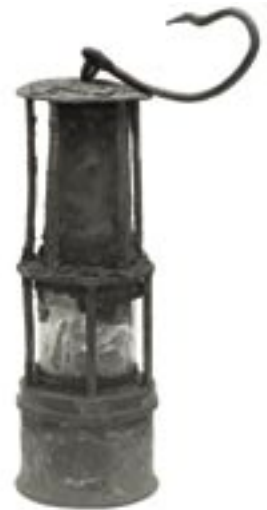
Abbildung 3: Benzinsicherheitslampe, die nach dem Grubenunglück auf der Zeche Radbod geborgen wurde (Quelle: Bergbau-Archiv beim Deutschen Bergbau-Museum Bochum).
