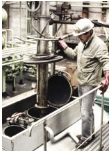
Abbildung 15: Messung der Benzolexposition bei der Rohbenzolverladung in einer Kokerei.
