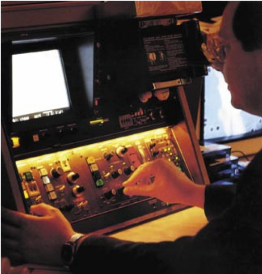
Abbildung 11a: Asbestuntersuchung mit dem Rasterelektronenmikroskop.
