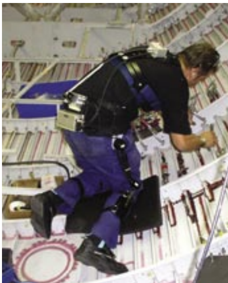
Abbildung 27: Flugzeugmechaniker trägt das CUELA-Messsystem (links); Computerdarstellung der Haltung und Bewegung (rechts).
