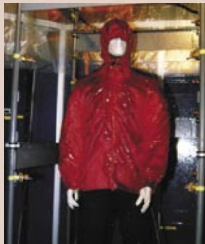
Beregnungsversuch an einer Wetterschutzkleidung im Prüflabor im Zentrum für Sicherheitstechnik.
