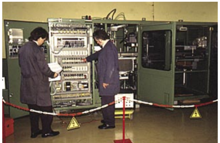
Abbildung 25: Prüfung klassischer elektromechanischer Steuerungen Anfang der 1980er-Jahre.
