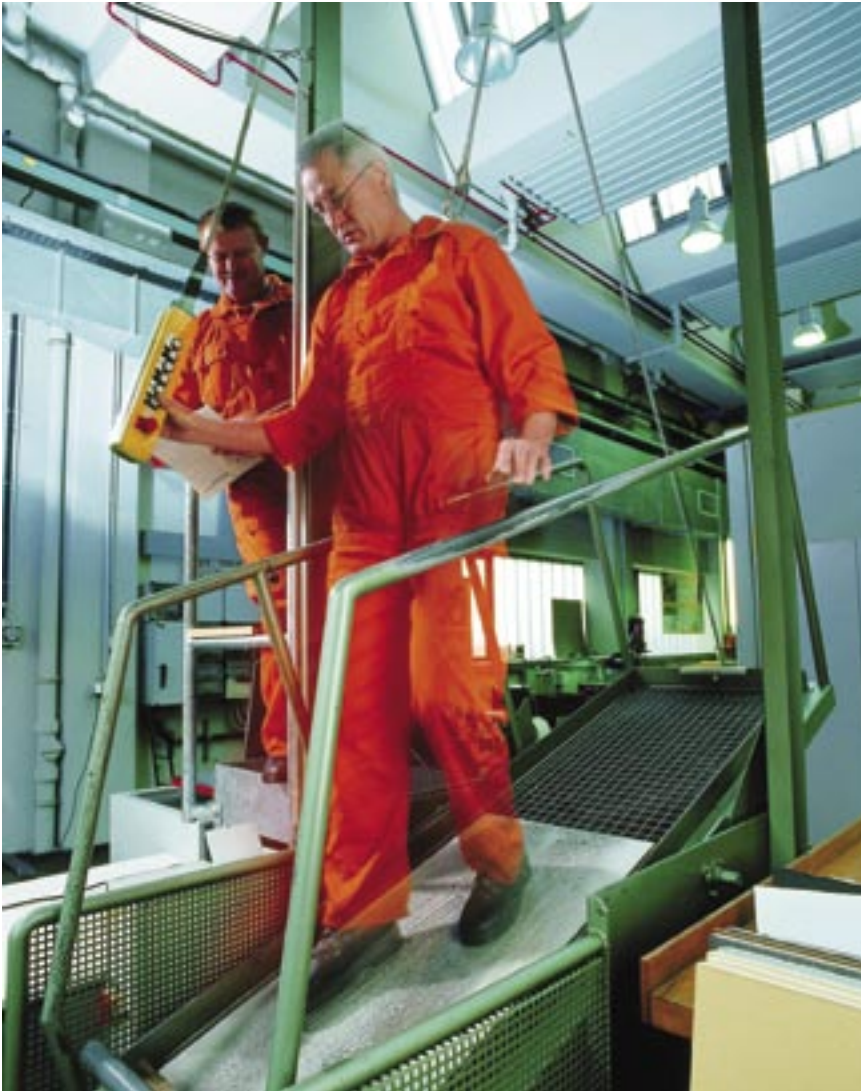
Abbildung 24: Prüfung der Rutschhemmung von Bodenbelägen und Schutzschuhen auf der schiefen Ebene durch „Begehen“.
