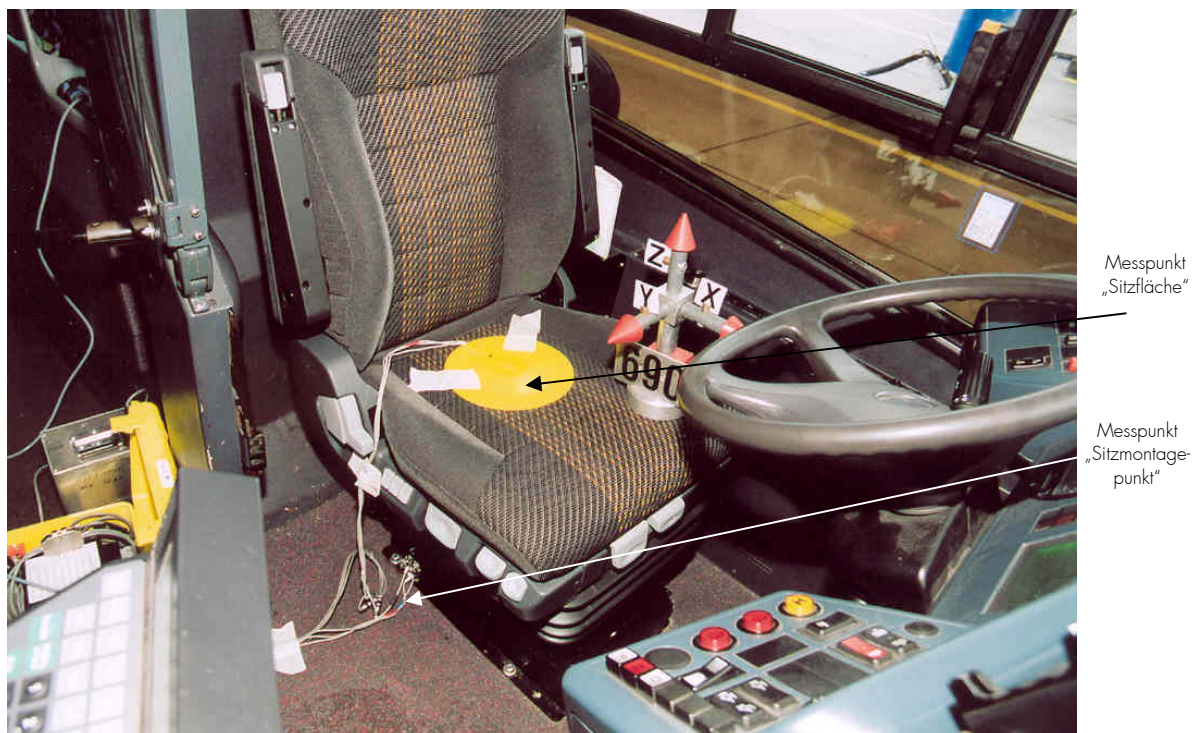
Abbildung 2: Lage und Befestigung der Messscheibe am Messpunkt „Sitzfläche“ und Befestigung der Beschleunigungsaufnehmer am Messpunkt „Sitzmontagepunkt“
