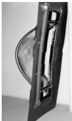
Abbildung 2-36: Beim Aufprall von Teilen aus der Befestigung gerissene Sichtscheibe
