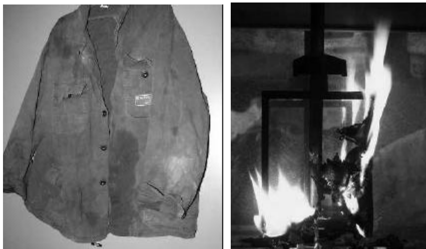
Abbildung 2-24: Getragene Arbeitsjacke und Entflammung der Arbeitsjacke im Laborversuch
