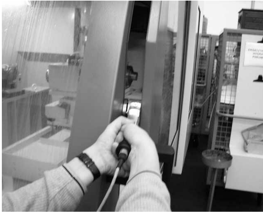
Abbildung 2-35: Schließkraftmessung an der Schutztür einer Werkzeugmaschine
