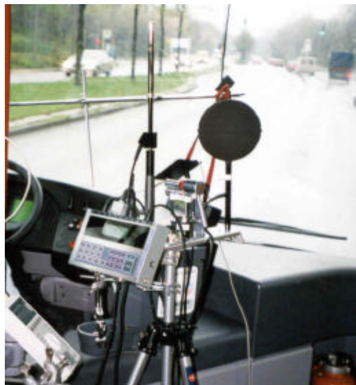
Abbildung 2-17: Klimamessungen an einem Fahrerarbeitsplatz
