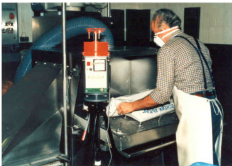
Abbildung Gefahrstoffmessung beim manuellen Entleeren von Kieselgursäcken
