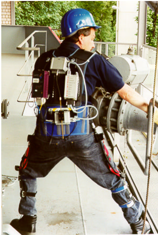
Abbildung Belastungsmessung beim Einfangen des Ladearms auf einem Tankschiff
