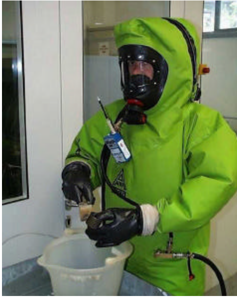
Abbildung 2-13: Nachstellung von Reinigungsarbeiten unter Verwendung benzolhaltiger Kraftstoffe – Versuchsperson durch Chemikalienschutzanzug geschützt
