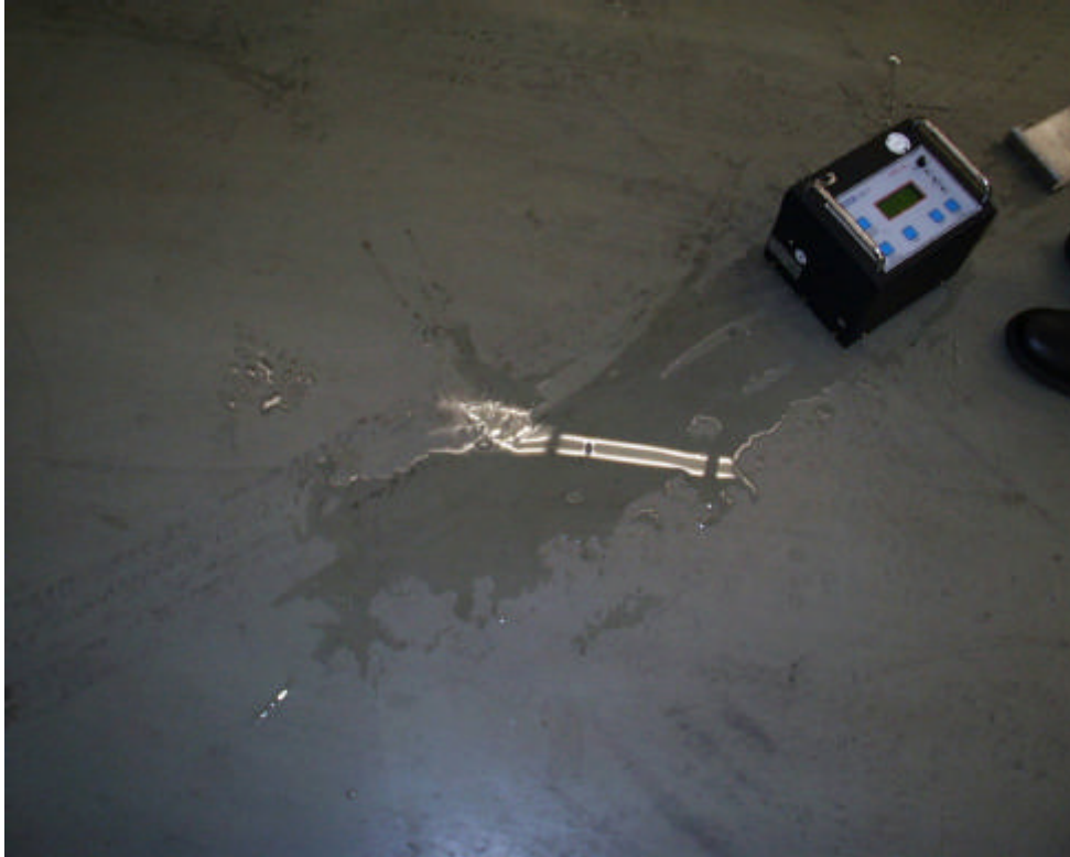
Abbildung 2-34: Messung der Gleithemmung eines Industriefußbodens in einer Werkshalle
