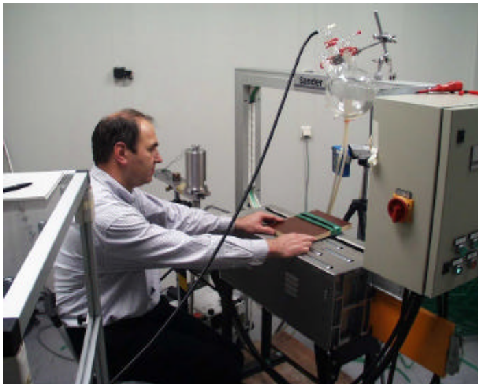
Abbildung 2-14: Messung der Gefahrstoffexpositionen an einer Umreifungsmaschine
