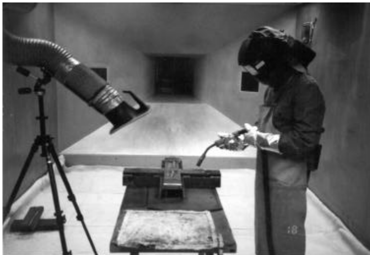
Abbildung Bestimmung des Erfassungsgrades für Schweißrauche
