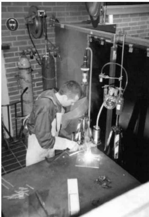
Abbildung 2-9: Messung ultrafeiner Aerosole bei Schweißarbeiten
