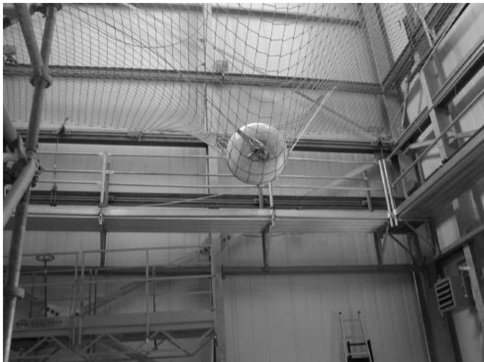
Abbildung 2-33: Netzverformung durch eine Kugel beim Fallversuch
