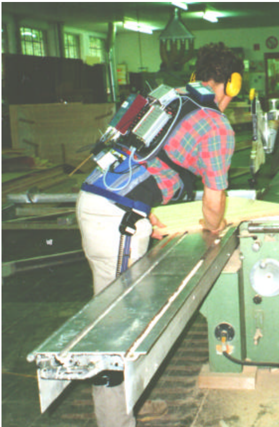
Abbildung Arbeiten an einer Kreissäge, Bewegungserfassung mit dem Messsystem CUELA-HTR
