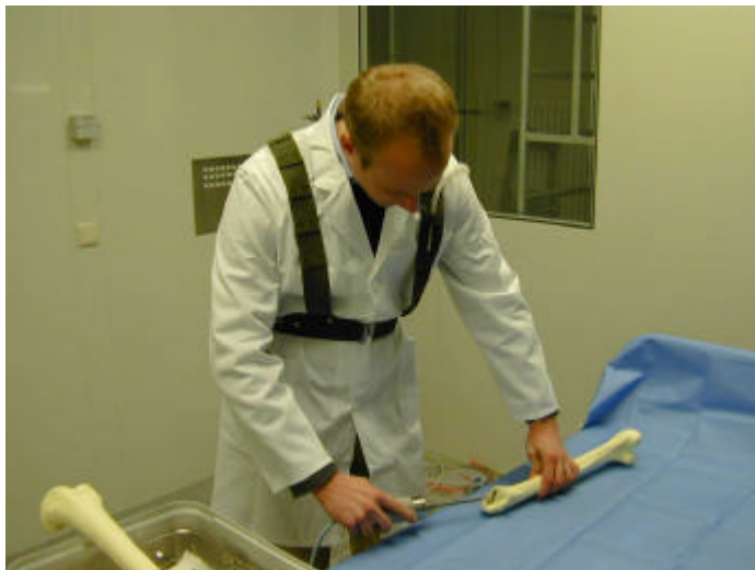
Abbildung Entfernen von Knochenzement im Laborversuch mittels Ultraschallgerät
