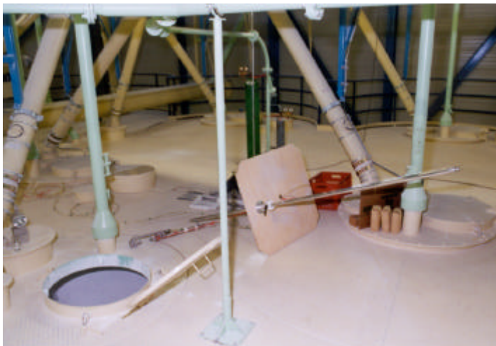
Abbildung 2-16: Messaufbau für Staubkonzentrationen in einem Zuckersilo
