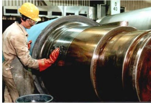
Abbildung 2-11: Offene Reinigung eines Walzenzapfens
