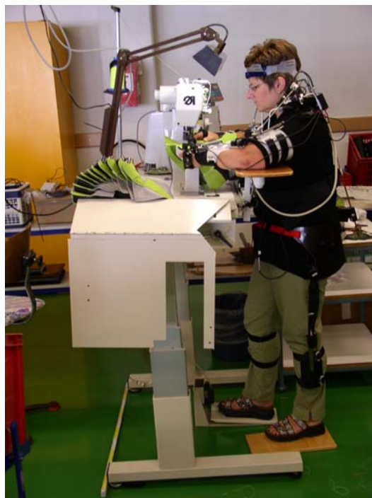
Abbildung 2-22: Belastungsmessung an einem Näharbeitsplatz
