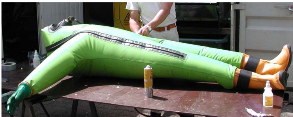
Abbildung 2-25: Dichtigkeitsprüfung am Schutzanzug
