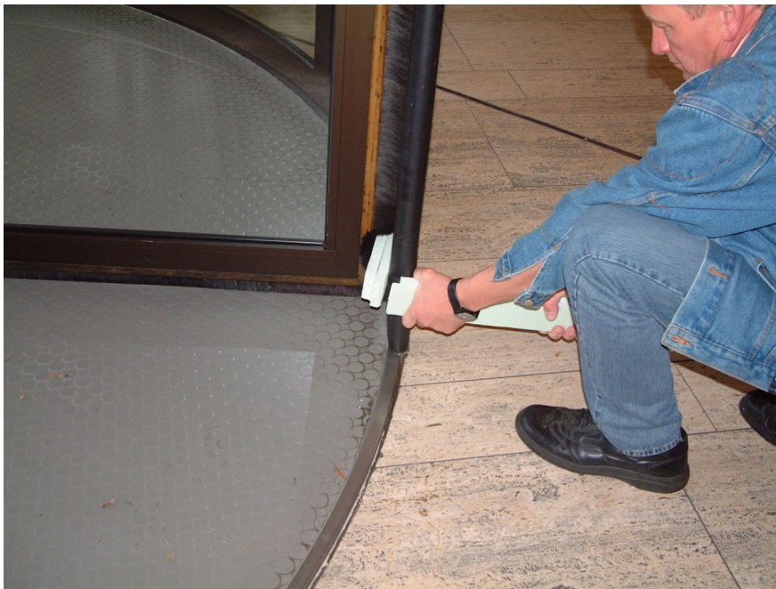
Abbildung Beurteilung der Kräfte zwischen den Schließ- kanten von Karusselltüren mit dem neuen Prüfkörper
