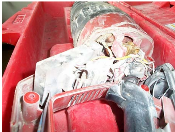
Abbildung 2-29: Staubablagerungen in der Nähe der Lüftungsschlitze
