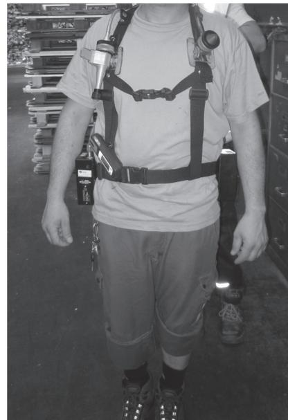
Beispiele für personengetragene Probenahmen am Arbeitsplatz bei Umschlag- und Lagerarbeiten.
