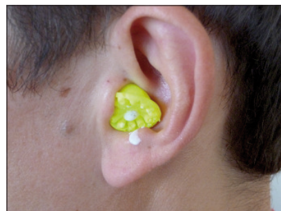
Bild 6 Stöpsel aus Bild 5 (Sitz unverändert), nachdem der Sondenschlauch gekürzt und die Öffnung verschlossen wurde.
