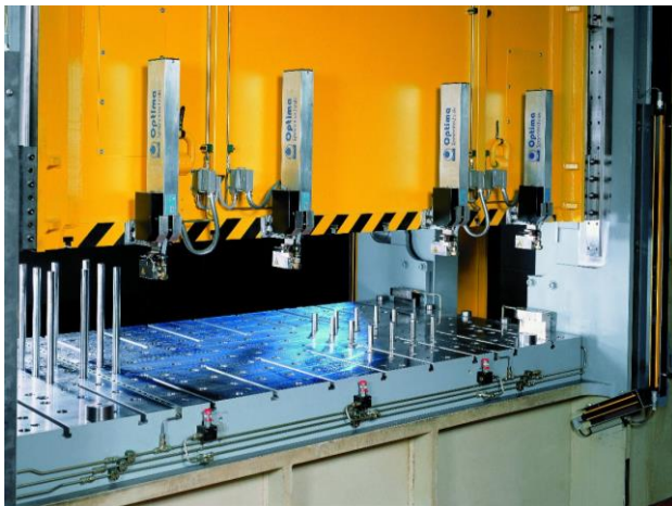
Bild 1: Werkzeugeinbauraum einer Presse
