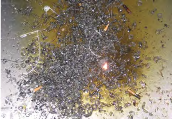
Bild 7: Zündquellen Zigarettenkippen, Brand im Spänebehälter
