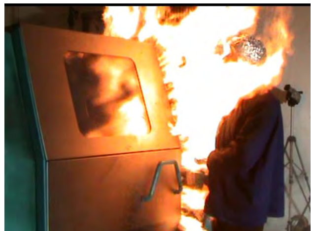
Bild 5: Flammenaustritt aus offenem Türspalt (6 cm) bei einer Verpuffung (Dummy)
