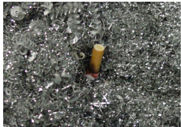
Bild 6: Zündquellen im Spänebehälter
