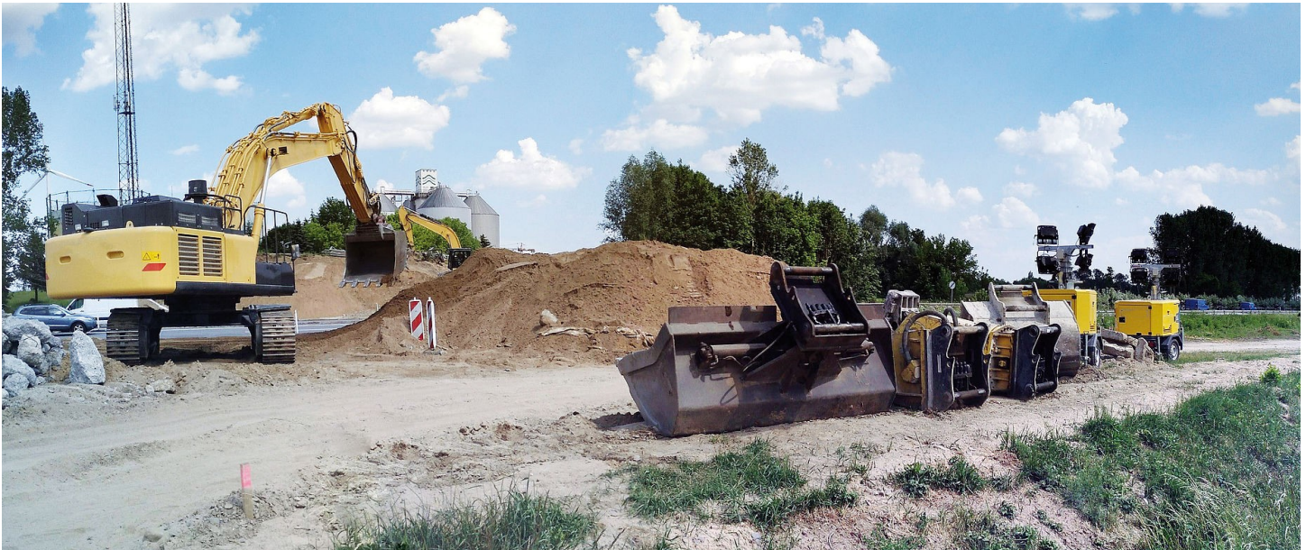
Anbaugeräte für verschiedene Anwendungen können über Schnellwechseleinrichtungen mit dem Bagger verbunden werden. | Bildquelle: Volker Mün
